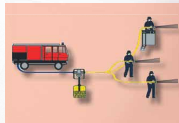
Мобильный FireDos мод. FD-DZ позволяет изменять длину рукавной линии во время работы, не ухудшая качество водного раствора пенообразователя
