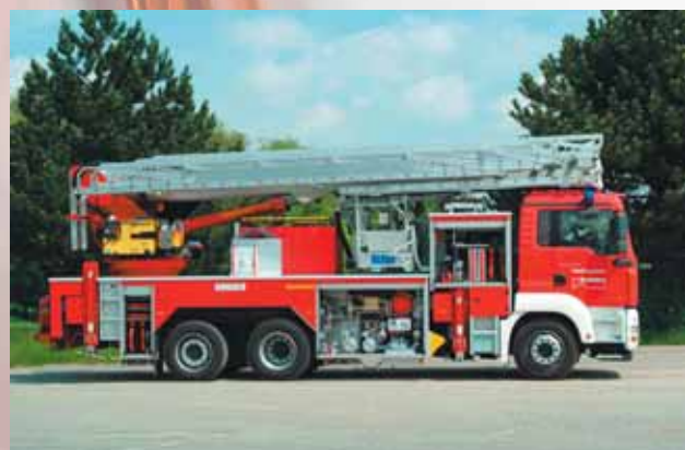
Системы FireDos часто устанавливаются на автолестницы и коленчатые подъемники, так как большое давление гидростатического водного столба оказывает незначительное влияние на систему.
