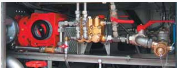
Система FireDos с плавным изменением дозирования в отсеке пожарного автомобиля
