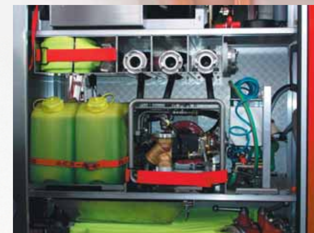
Дозаторам FD-DZ требуется немного места, и они могут быть использованы непосредственно с выдвижного лотка
