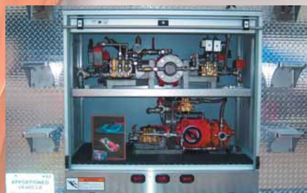
FD2500/0,3-3% в контейнере для пенного пожаротушения
